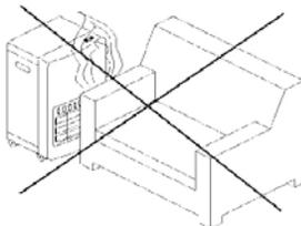
5. Neumisťujte kamna podél zdi nebo v blízkosti záclon a jiných hořlavých materiálů. Minimální vzdálenost by měla být respektována: 20 cm od bočních stran, 150 cm od přední strany. VŽDY směřujte na střed místnosti. Zvláštní pozornost věnujte v případě, že kamna stojí na povrchu, kde se mohou otočit na kolečkách, pokud o ně zavadí dítě nebo pes, atd.
